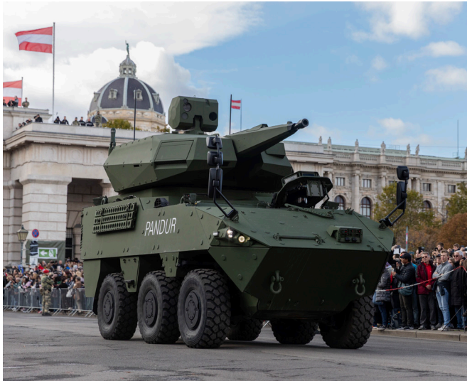
Der Skyranger ist ein bodengestütztes Luftverteidigungssystem und wird für den beweglichen Schutz der Landstreitkräfte eingesetzt.
